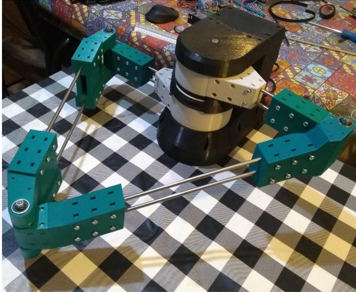
Figura 1.1: Doble *SCARA* paralelo o mecanismo de cinco barras construido.
